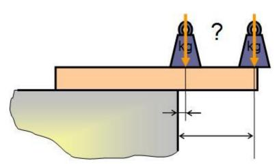
Ces distinctions sont représentables par le modèle de moment d'une force qui est l'aptitude d'une force à faire tourner un système mécanique autour d'un point donné.
