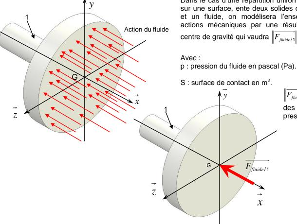
Dans le cas d'une répartition uniforme d'une pression sur une surface, ente deux solides ou entre un solide et un fluide, on modélisera l'ensemble des micro actions mécaniques par une résultante globale au centre de gravité qui vaudra  $\|\overrightarrow{F_{fluide/1}}\| = p.S$
